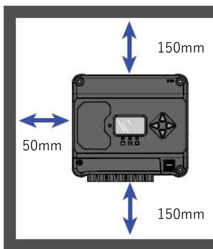
図 3.2 通気のための取り付け間隔
