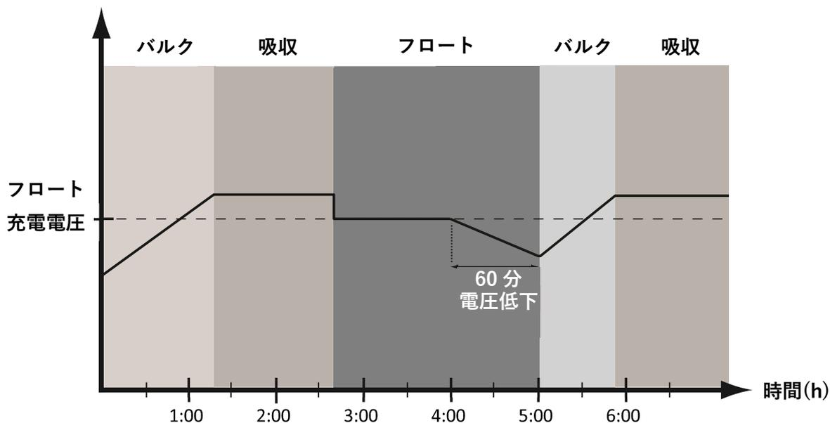
図 4.4 吸収フロート充電の中断
