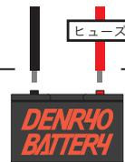
②プラス端子と接続した配線にヒューズを接続し、各配線をバッテリーに接続してください。アース端子手前の赤 LED が点灯した場合、極性を逆に接続しています。配線を正しく修正してください。
